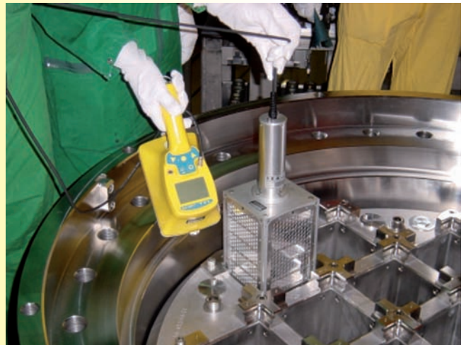
CoMo mit Sonderdetektor (4 aktive Detektorflächen) zur Kontaminationskontrolle von BE-Lagerschächten
